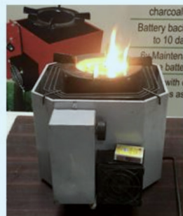
चित्र 98: कुकस्टोव में पेलेट का उपयोग करने की प्रक्रिया (स्रोत: इकोसेंस उपकरण) 154
