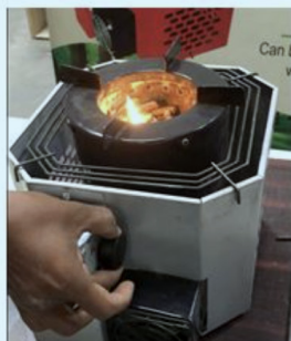
चित्र 98: कुकस्टोव में पेलेट का उपयोग करने की प्रक्रिया (स्रोत: इकोसेंस उपकरण) 154
